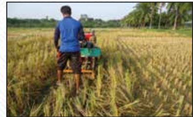
টু-হুইল ট্রাক্টর (2-wheel tractor) দ্বারা স্ট্রিপ টিলেজে ৫০% ধানের খড়ের মধ্যে মসুরের বীজ বপন ও সার প্রয়োগ।
